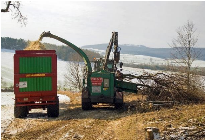
Abb. 11: Das Schnittgut wurde zur energetischen Verwertung direkt vor Ort gehackt (Foto: F. Grawe)
