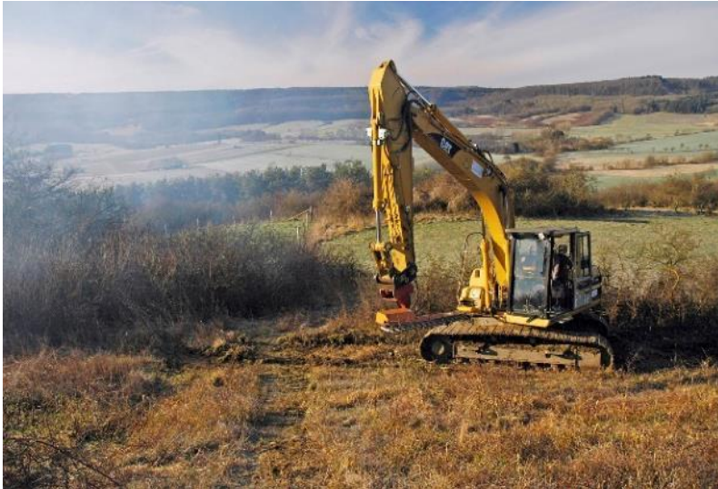
Abb. 10: Das Freistellen verbuschter Magerrasen erfolgte bodenschonend mit am Kettenbagger montiertem Schneidwerk (Foto: F. Grawe)
